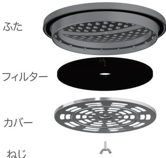
バスケットリッドは、工場出荷時に組み立てて出荷をされております。単体で同梱はされていません。汚れがひどい時に分解してお手入れをしてください。フィルターは水洗いをして風通しの良い日陰で乾かしてください。
